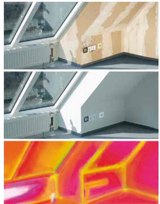
Bild 12: Thermografieaufnahme (unten) eines Bauteils mit Installationsgeräten. Rote Farben bedeuten warme Bauteile. Je mehr die Farben über gelb, grün sich hin zu blau entwickeln, je kühler ist das jeweilige Bauteil. Im Bild deutlich zu erkennen die kühler als die Umgebung erscheinenden Installationsgeräte.
