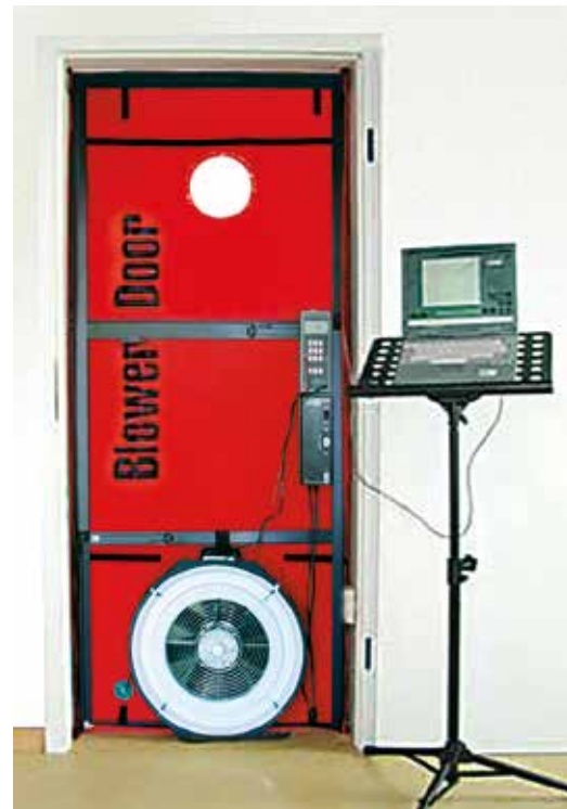
Bild 27: Luftdichtheitsmessung nach der „Blower-Door-Methode“
